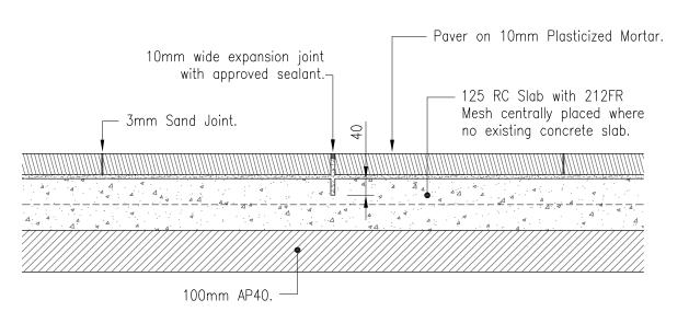
CONTRACTION JOINT THROUGH PAVING SCALE 1:10
